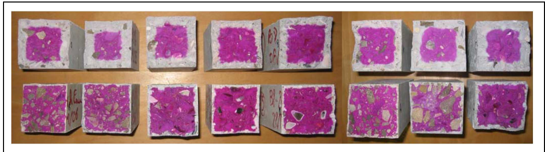
Bild 2.87 Karbonatisierungstiefen nach 1 Jahr Lagerung bei 50% RL [Rozière 2007]. Die Würfel der oberen Reihe wurden ausgeschalt, wenn die Druckfestigkeit 50% des 28-Tage-Wertes erreicht hatte. Die Würfel der unteren Reihe wurden 28 Tage in Wasser nachbehandelt.
